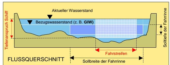
*Fahrstreifen eines Schiffes entsprechend dem Tiefgang (Tiefenanspruch) unter aktuellem Wasserstand*
